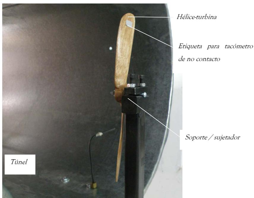
Figura 3. Arreglo experimental para medir la velocidad ganada por la turbina-hélice.
