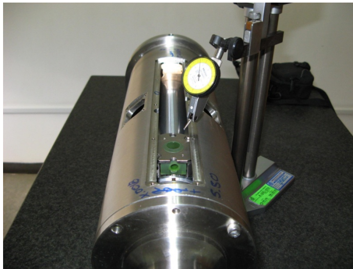
Figura. 8. Encoder lineal montado en actuador.
