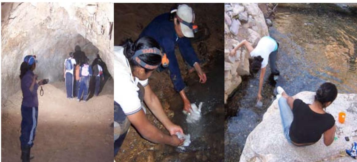
Foto 6. Traslado de los 50 kg de Cloruro de Sodio en el interior de la Cueva del Agua, disolución de la sal y el registro de SDT, en el Manantial, El Higueron. Febrero de 2008. EXCAV-COBAQ 13
