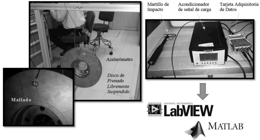
Figura 4.2. Equipo usado para la adquisición de datos en pruebas de impacto del disco de freno.
