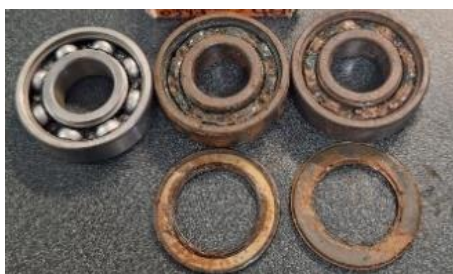
Figura 2. Gradualidades de fallo en rodamientos metálicos tipo 6203 2RS/C3.
