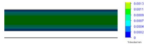
Figura 5.- Perfil de velocidad del fluido
