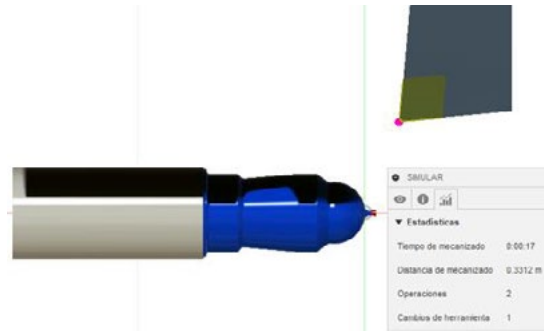
Figura 2: Ejemplo CAM de Pieza para Torno CNC en Software Fusión 360
