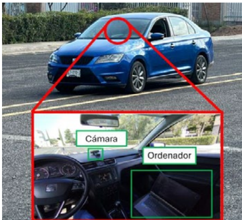
Fig. 1: Vehículo con el sistema de adquisición de datos
