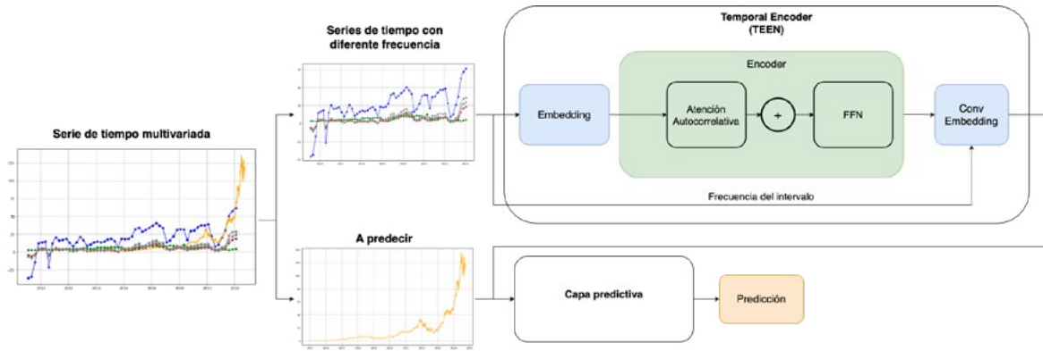
Figura 2. Arquitectura del temporal encoder TEEN.
