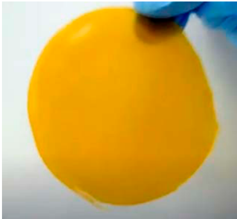
Película (prototipo de material de empaque) derivada de la luteína
