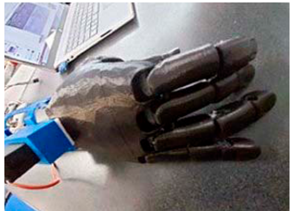
Prototipo de mano articulada para movimiento de pinza bidigital
