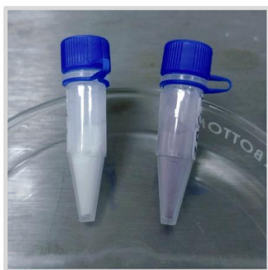
Figura 13: Fotocatalizadores de \text{TiO}_2 (izquierda) y \text{Au/TiO}_2 (derecha).
