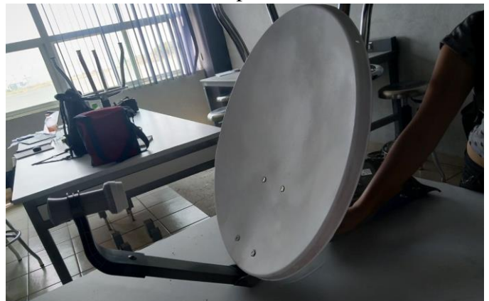
Figura 1: Antena tipo offset para banda KU de 60 cm de diámetro con un LNB sencillo.
