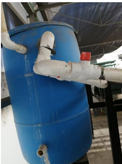
Fig. 4 En la figura se puede apreciar el tanque pecera de una capacidad de 300 litros aproximadamente, con los tubos que recirculan el agua.
