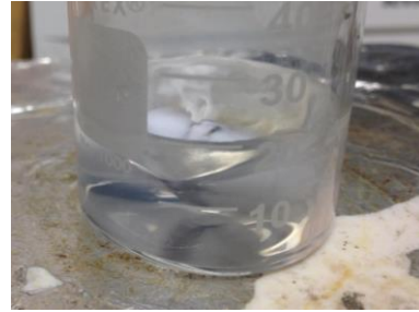
Figura 9. Coloración de solución \text{AgNO}_3 con aceite de limón
