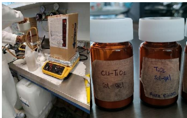
Figura 1. Síntesis de NPs de Cu-TiO 2 y TiO 2 por sol-gel.
