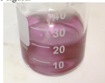
Figura 6. Coloración de Nps de Au con aceite de limón
