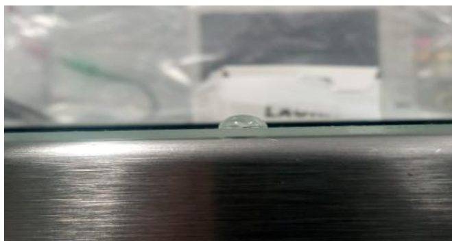
Figura 4: Gota de Agua sobre portaobjetos de vidrio recubierto con la Síntesis #1
