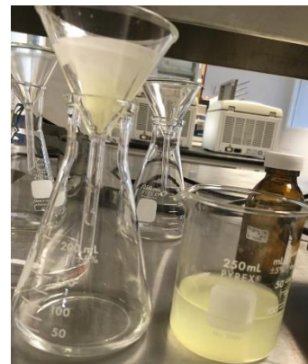
Fig. 4 En el proceso de filtrado se puede observar la diferencia de color entre la solución (derecha) antes de filtrar y después de filtrar (izquierda)
