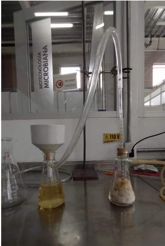
Imagen 6 Sistema de filtración al vacío para la separación física de la infusión de la albahaca
