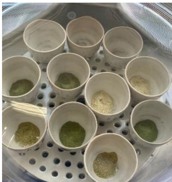
Imagen 2. Crisoles en desecador con 2.5 g de muestra
