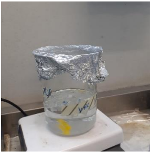
Figura 2: Diálisis de las fracciones 1 y 2 para la extracción de urea mediante fuerzas osmóticas.
