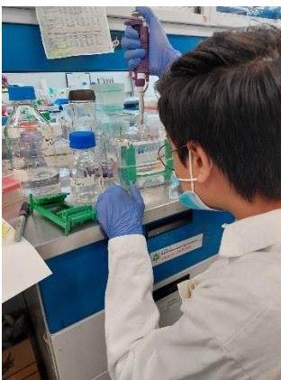
Carga de muestras en geles de poliacrilamida para electroforesis.
