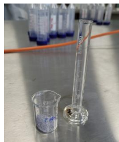
Fig 3. Prueba para Densidad Aparente
