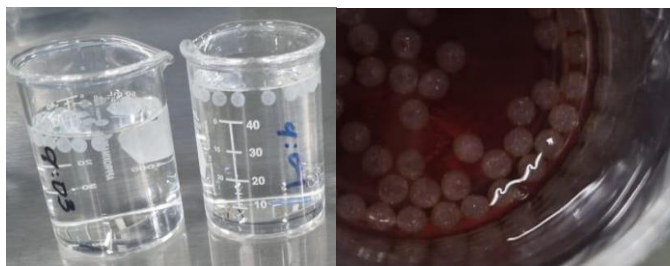
Fig 6 y 7. Perlas recién hechas en GDL y cargadas en fresco en extracto acuoso de pulpa de café.
