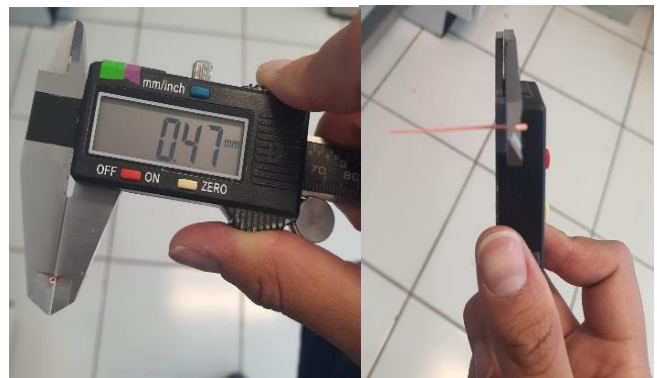
Figura 3. Medición en tres puntos de las puntas de gutapercha
