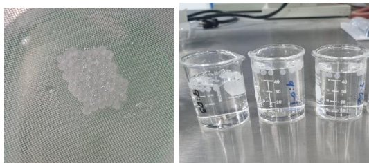
Fig. 1 Perlas de hidrogel APA:GX sin cargar.
