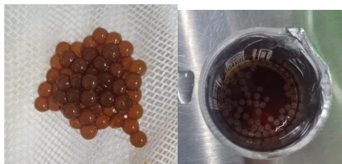
Fig. 2 Perlas de hidrogel cargadas en extracto de café por 6 h.
