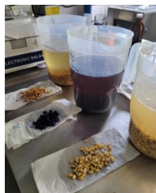
Fig 4. Prueba para índice de Absorción de Agua
