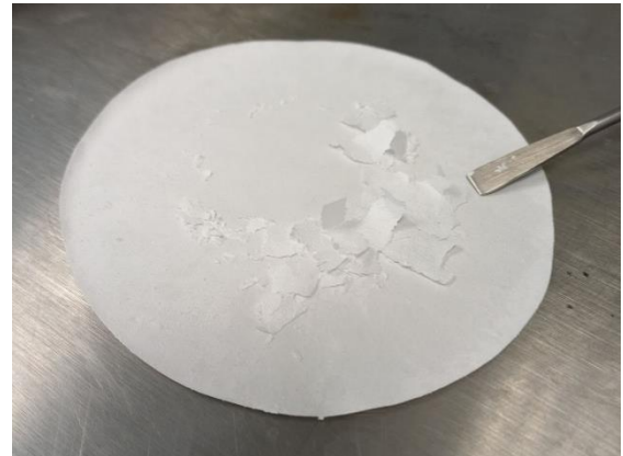
Figura 6. Raspado del compuesto tras dejarlo filtrar.
