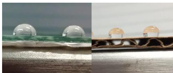
Fig. 2 Fotografía tomada para la medición de ángulo de contacto en a) vidrio y b) cartón.
