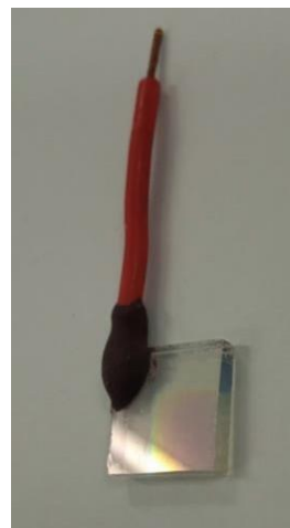
Figura 1: Electrodo fabricado con la película delgada \text{TiO}_2\text{-Ag}
