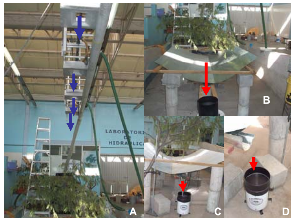
Fig 2. Simulador de lluvias. Las flechas azules indican los 4 aspersores del simulador, las flechas rojas muestran los pluviómetros.
