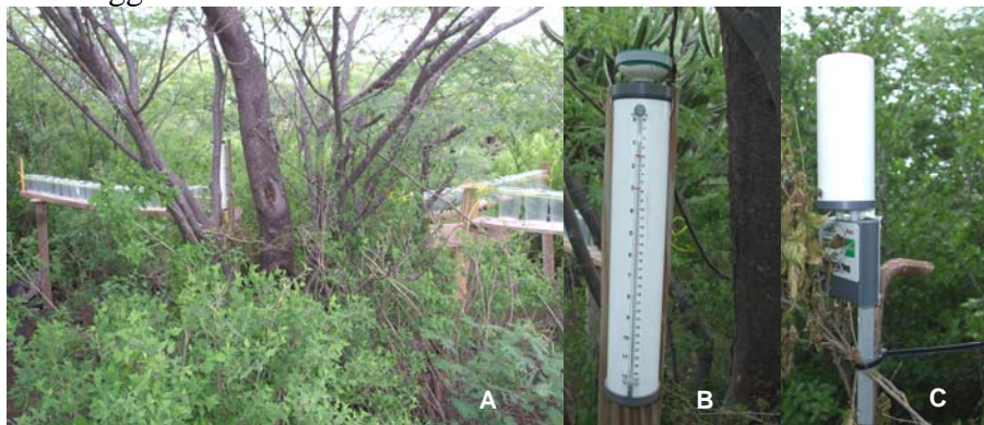
Fig 1. Instrumentación de L. microphylla en Campo. A) Recolección de la percolación, B) Evapotransporimetro, C) Pluviometro.
