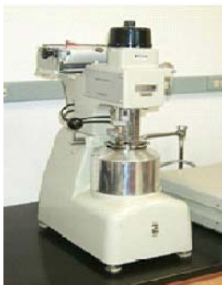
Fig.2 Mini inyector, para moldeo
